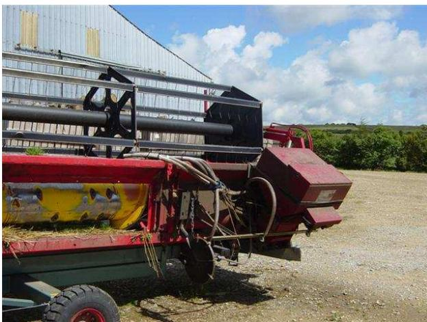
coupe de la moissonneuse, avec semoir sur le côté et système de semis sur la largeur.
